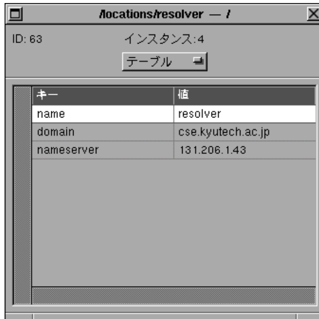
図 5: NetInfo.app でネットワークドメイン ('/') の /locations/resolver を見ているところ。domain, nameserver が設定されている。
